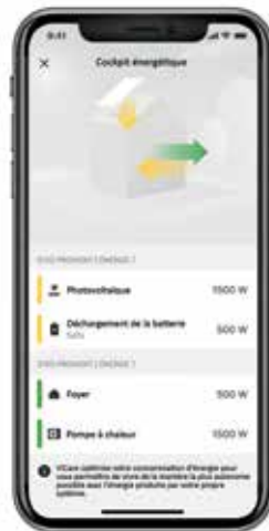
Le cockpit énergétique de l'application ViCare offre à l'utilisateur une vue d'ensemble des flux énergétiques de son habitation.
