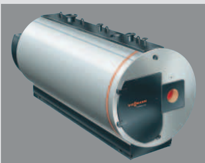
Vitomax 200 – Chaudière vapeur basse pression à triple parcours de fumées, 2,6 à 4,5 t/h (1890 à 3270 kW)
