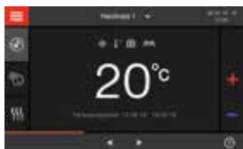
5" touchscreen met kleurendisplay van de Vitotronic 200-regeling (type HO2B)
