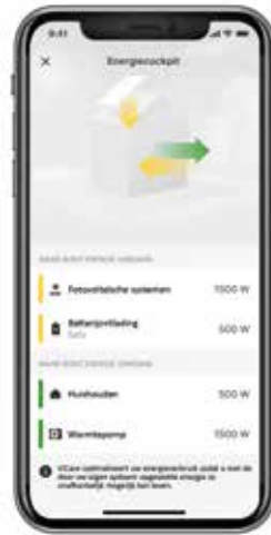
Via de energiecockpit in de ViCare-app kan de gebruiker de energiestromen van zijn gezin in het oog houden.
