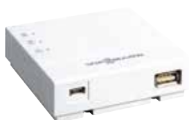
Vitoconnect avec branchements pour le bloc d'alimentation secteur (gauche) et pour la connexion des données
