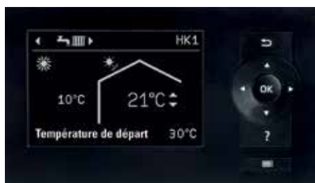
Ecran de la régulation de pompe à chaleur Vitotronic 200
