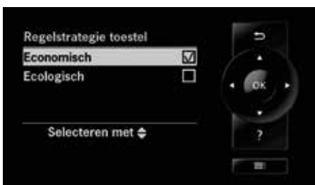
Vitotronic 200-regeling met Hybrid Pro Control Keuze uit twee bedrijfsmodi: "Economisch" of "Ecologisch"
