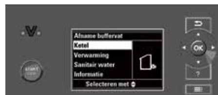
Ecotronic-regeling met groot verlicht display en tekstweergave op meerdere regels, alsook vereenvoudigde inbedrijfstelling (inbedrijfstellingswizard) via 'Plug and Work'-functie
