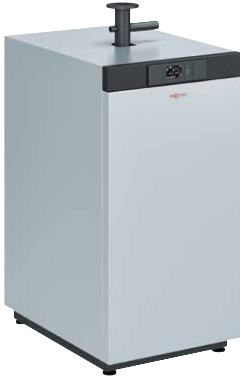
Vitocrossal 100 Gascondensatieketel met een nominaal thermisch vermogen van 69 tot 318 kW
